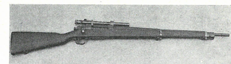
Amerikanisches Gewehr M-1903 mit Zielfernrohr Kaliber 7,62 mm, Hülsenlänge 63 mm. Wurde nach in der B-Gendarmerie verwendet, kam aber an die Leistungen des Karabiners 98k nicht heran
