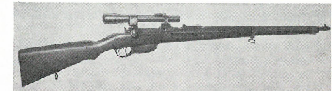
Österreichisches Gewehr M 1895 mit dreifachem Zielfernrohr Kaliber 8 mm, Magazin für 5 Patronen, System Mannlicher, Wien, Heeresgeschichtliches Museum
