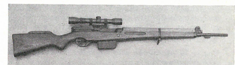
FN-Selbstladegewehr mit vierfachem Zielfernrohr Magazin für 10 Patronen
