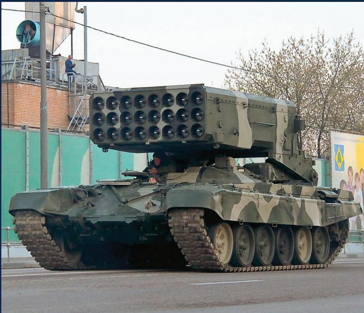
TOS-1 ist ein Mehrfachraketenwerfer und verschießt thermobarische Sprengköpfe. Dieser Munitionstyp verteilt durch Sprengung eine explosive Aerosolwolke im Zielraum. Durch eine unmittelbar folgende Zündung verpufft die Wolke und erzeugt eine Hitze- und Druckwelle.
