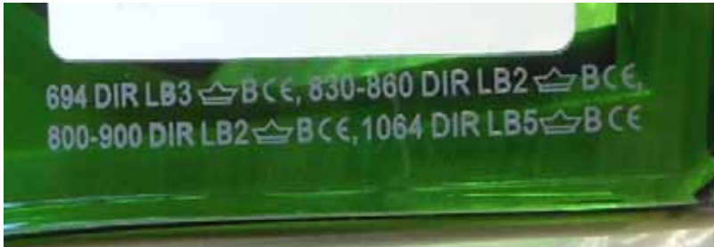
Abb. 9: Schutzstufen der Laserschutzbrille für verschiedene Wellenlängen-bereiche, zB: OD=2 im Wellenlängenbereich 800 nm bis 900 nm (800-900 DIR LB2) und OD=5 bei einer Wellenlänge von 1064 nm
